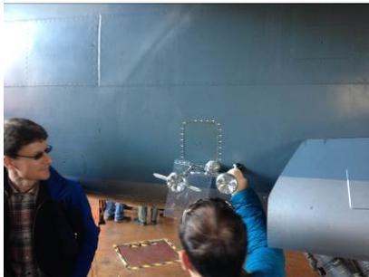
Die beiden Schulen, das Lycée Trégey und der Aéro-campus, stehen in engem Kontakt. So wurde z. B. zuletzt ein Werkzeug für Montagearbeiten an der Mirage entwickelt, das dazu dient, Schrauben, die nicht mit den üblichen Werkzeugen zu lösen sind, durch Hebelwirkung über einen Drehpunkt, der an jeder anderen Schraube
